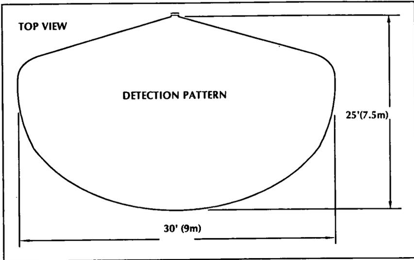
**TYPICAL BISTATIC MICROWAVE DETECTION PATTERN**
